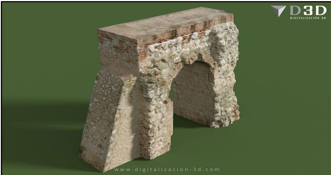
Ilustración 1: Ejemplo de modelo 3D generado mediante fotogrametría. Fuente: [www.digitalizacion-3d.com](http://www.digitalizacion-3d.com)
