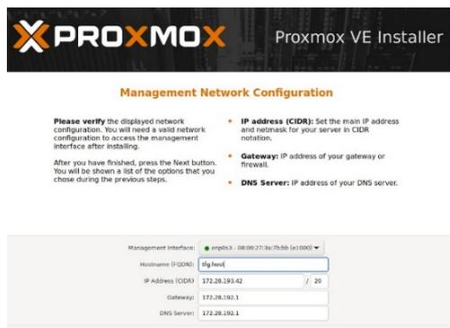
Figura 9. Configuración de la red para la instalación de Proxmox.
