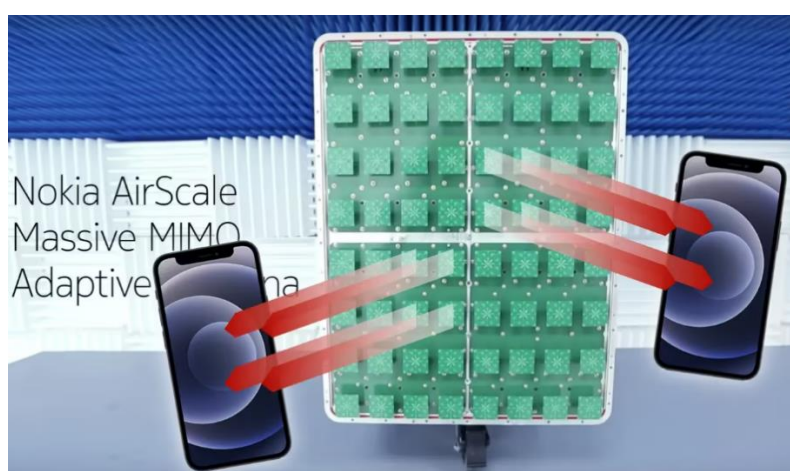
Figura 3.2. Parches radiantes en antenas Nokia AirScale Massive MIMO. Fuente [40]
