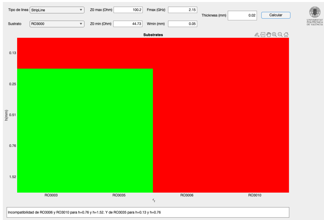
Ilustración 29: Prueba 1 Stripline f=2,15 GHz W_{min}=0,05 mm y t=0,02 mm
