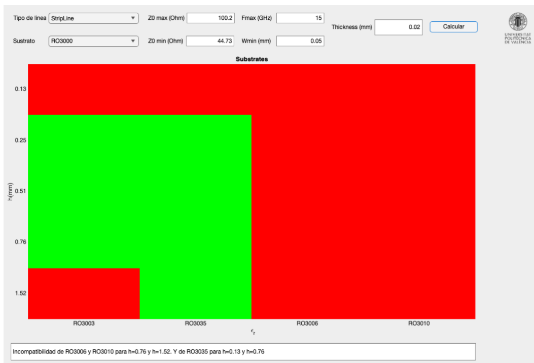
Ilustración 29: Prueba 4 Stripline f=15\text{GHz} W_{\min}=0,05\text{mm} y t=0,02\text{ mm}
