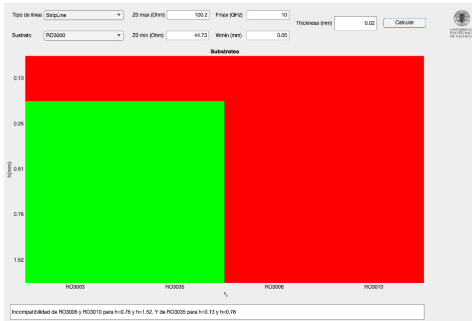
Ilustración 28: Prueba 3 Stripline f=10\text{GHz} W_{\min}=0,05\text{mm} y t=0,02\text{mm}
