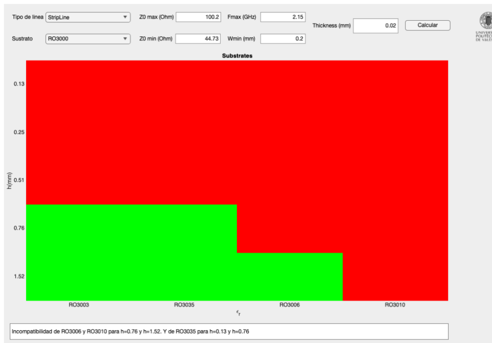
Ilustración 27: Prueba 2 Stripline f=2,15\text{GHz} W_{\min}=0,2\text{mm} y t=0,02\text{mm}
