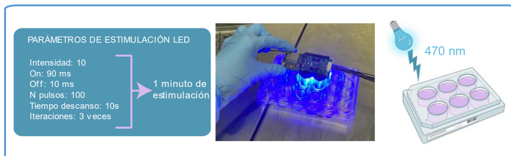
Figura 5. Parámetros de estimulación optogenética celular con el dispositivo LED. Se realizaron 3 ciclos de estimulación con 10s entre cada uno. Cada ciclo consistió en una intensidad de 10 y 100 pulsos 90 ms on y 10 ms off a 470 nm.
