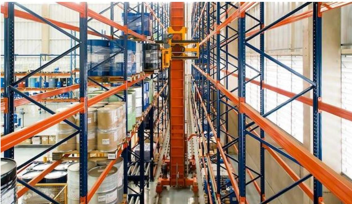
Figura 18: Estanterías con transelevador automático (Mecalux. Recuperado de: <https://www.mecalux.es/blog/estanterias-pasillo-estrecho>, 2024)
