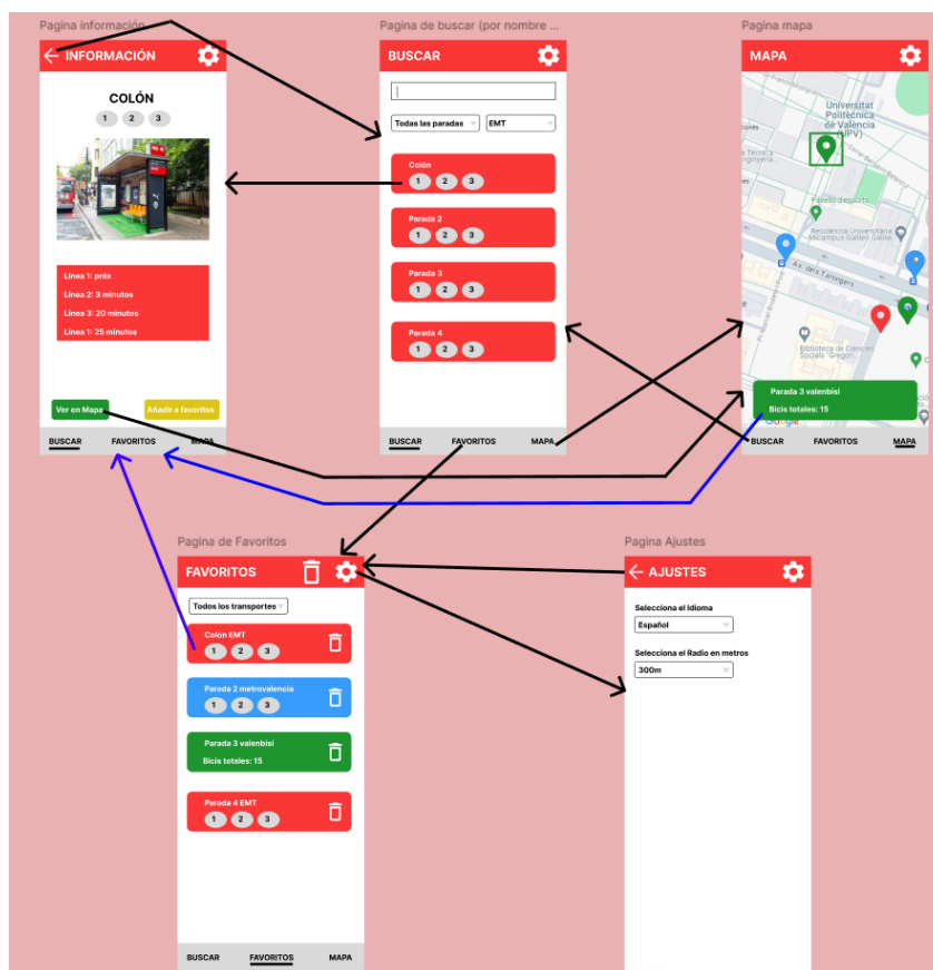
Figura 14: Diagrama de flujo de navegación entre pantallas
