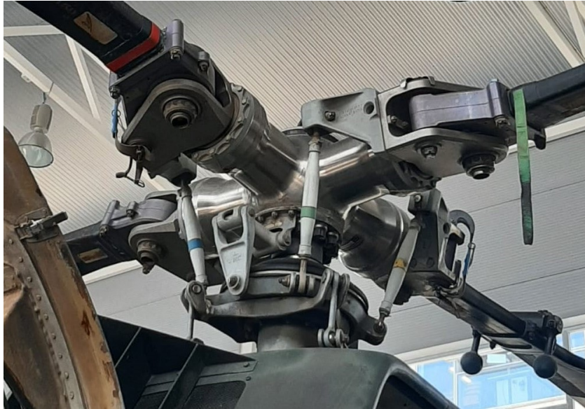
Figura 3.2: Scissors link en el rotor principal de un helicóptero. Fuente: elaboración propia.
