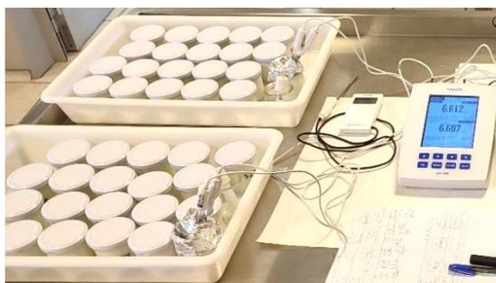
**Figura 4.** pHmetro de doble canal para medición continua durante el proceso de fermentación del kéfir.
