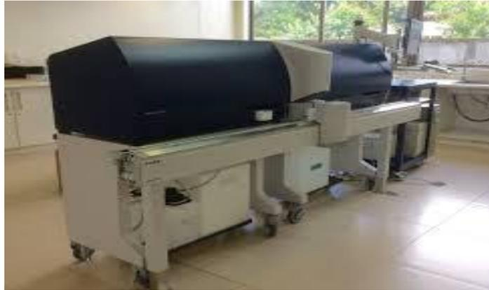
**Figura 6.** Equipo de infrarrojos Milkoscan FT+ para análisis de composición del kéfir
