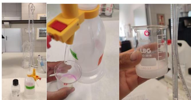
**Figura 5.** Determinación de la acidez valorable del kéfir según el método Dornic.
