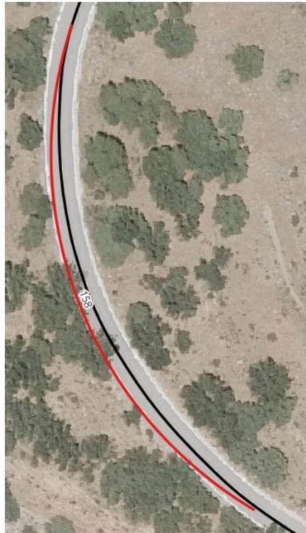
Figura 33. Elemento circular clasificado como error grosero
