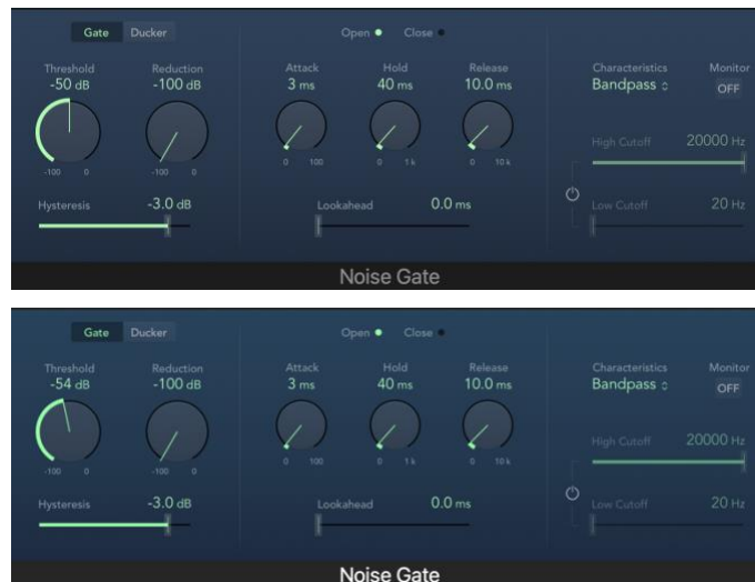
Figura 25. Ejemplos de puerta de ruido aplicadas a los canales del micrófono multipatrón (arriba) y dinámico (abajo). Figura de elaboración Propia.
