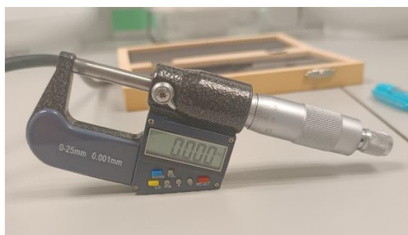
Figura 13. Micrómetro digital para la medida de los espesores en los ensayos de permeabilidad y de propiedades mecánicas.
