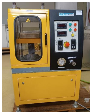
Figura 9. Prensa empleada para la elaboración de films por termoprocesado
