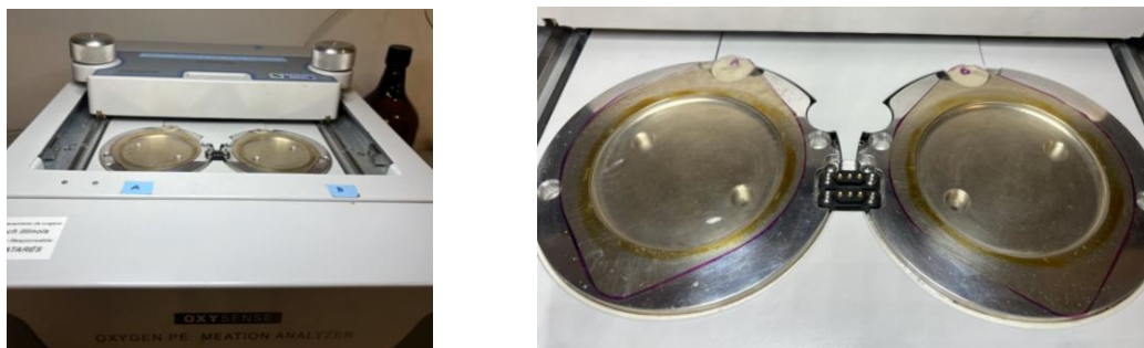
Figura 17. Izquierda: Ox-Tran; derecha: muestras de los films para el ensayo de permeabilidad al oxígeno.
