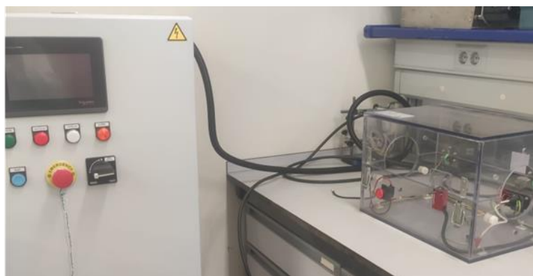
Figura 10.- Montaje experimental del sistema PEF: Generador y cámara de seguridad para la realización del tratamiento
