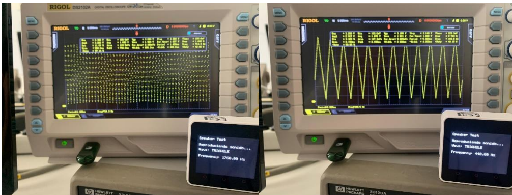
Figura 47: prueba de onda triangular a 880Hz
