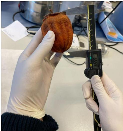
*Figura 7. Pie de rey para medición de diámetro longitudinal.*
