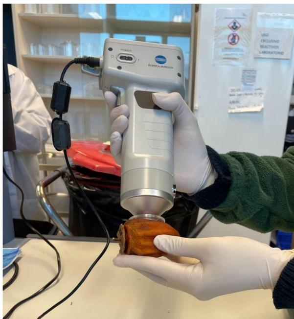
*Figura 8. Medición del color mediante un espectrocolorímetro Minolta.*
