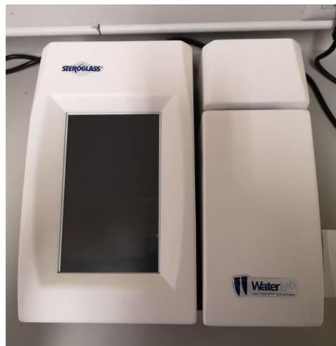
*Figura 5. Medidor de la actividad de agua.*
