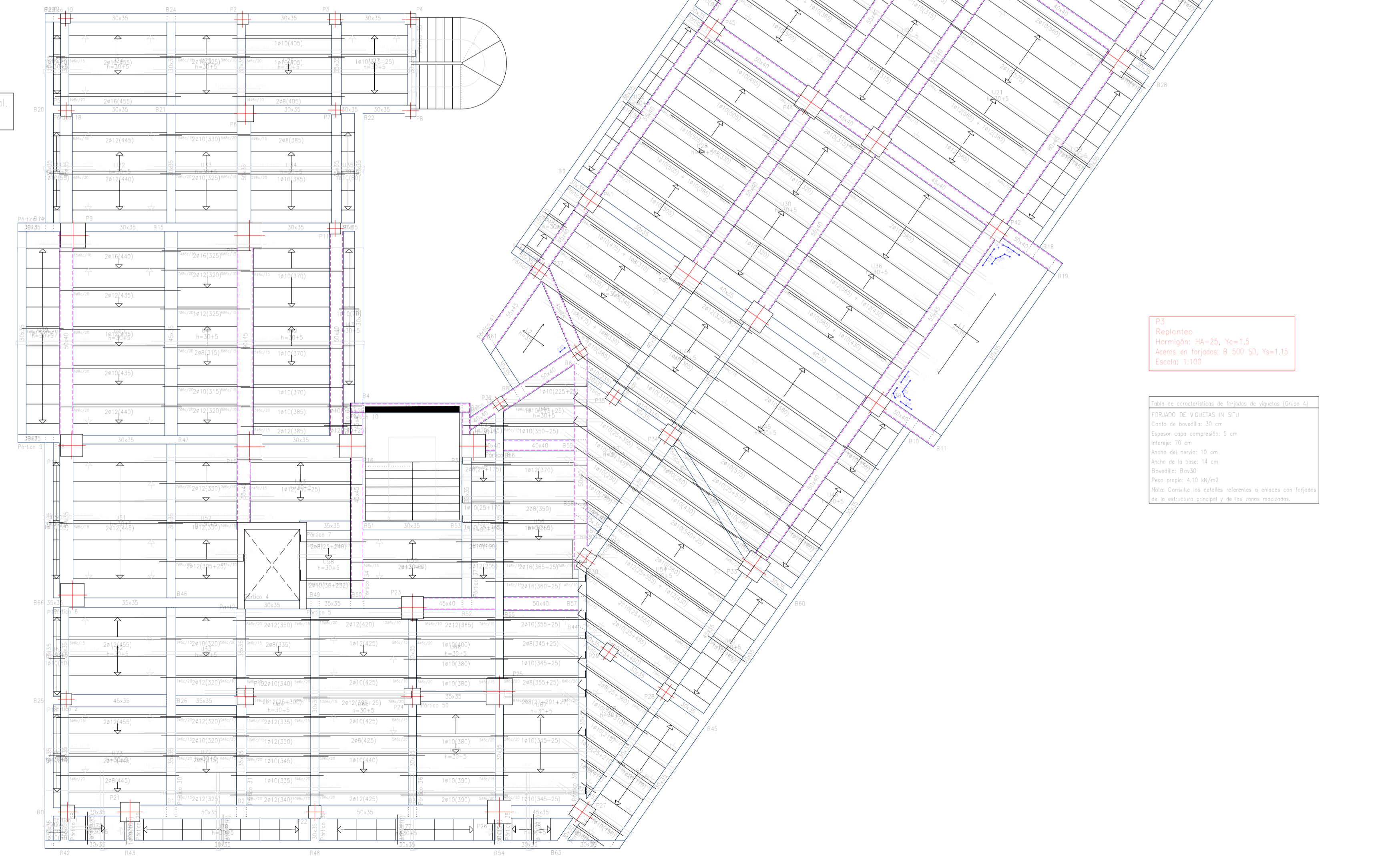
Transición a losa maciza de igual canto con forjado unidireccional. Viguetas paralelas.
