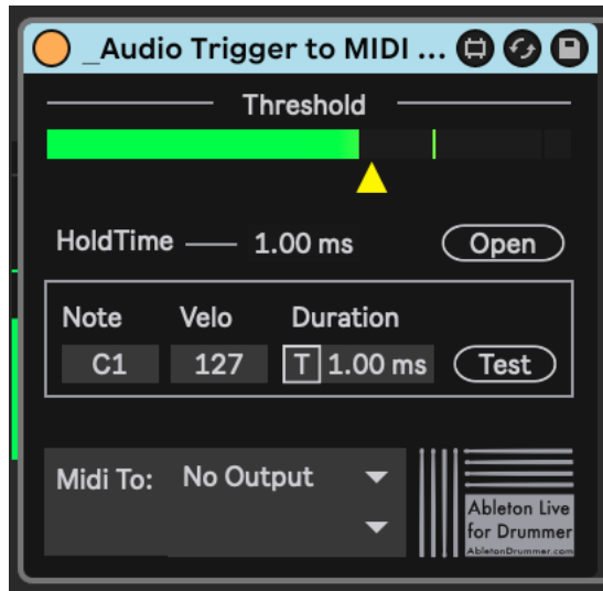
Fig. 15. Objeto de Max utilizado para convertir transitorios de audio en notas MIDI. Fuente: propia.
