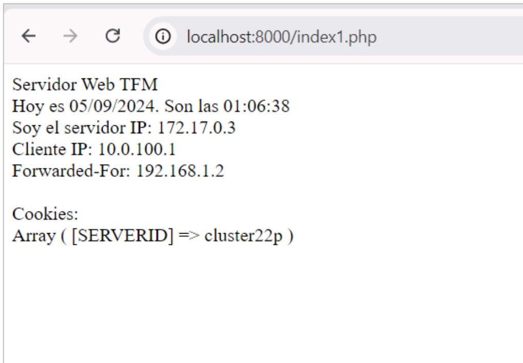
Figura 100 - Prueba externa de funcionamiento de HAProxy - Modo HTTP
