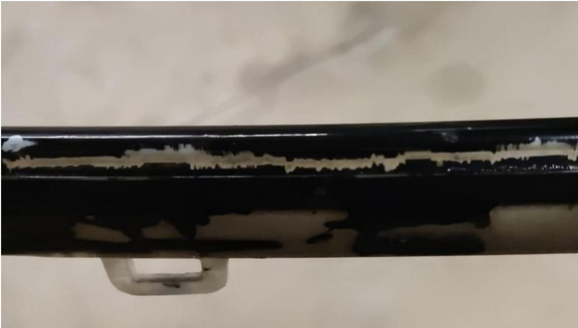
*Figura 6.4 Decapado Continuo sin adaptación*
