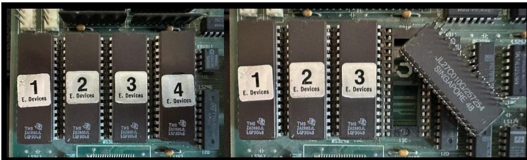
Imagen 22. Eeproms modelo TMS27C010A de 32 pines; pertenecientes a PCB GX072 (Konami, 1991) con el videojuego The Simpsons (Konami, 1991). Imágenes propias.
