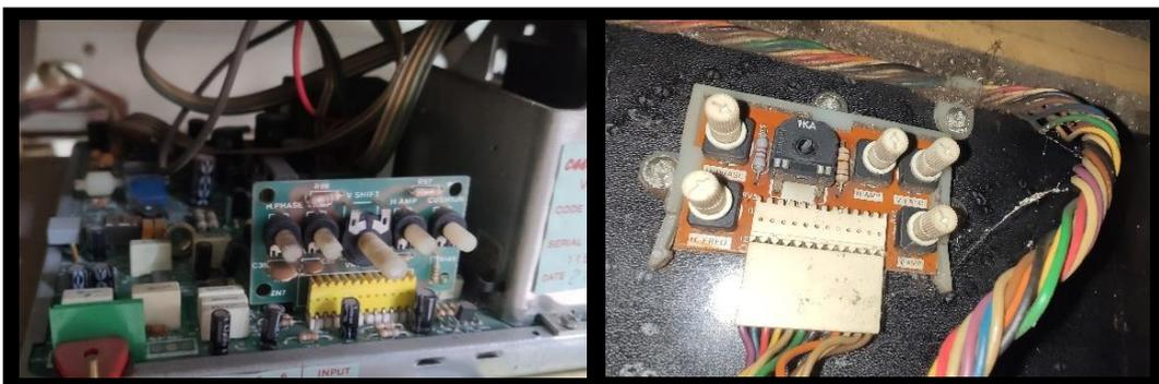
Imagen 8. De izquierda a derecha: controladora de sincronismos insertada en chasis modelo Vi 2500 (CA&G, 1992) y controladora de sincronismos externa al chasis localizada en el interior del Control Panel de una máquina modelo Video Sonic (Segasa, 1990). Imágenes propias.
