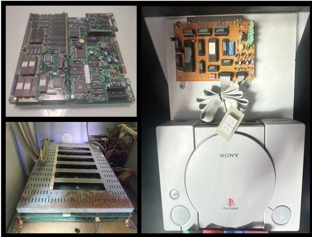
Imagen 5. Arriba izquierda: PCB Modelo Sega System 32 del videojuego Golden Axe: The revenge od death adder (Sega, 1991); abajo izquierda: PCB lectora de cartuchos del sistema MVS modelo MV-6F (SNK, 1990); derecha: videoconsola doméstica PlayStation (Sony, 1994) intervenida para su conexión con el sistema Jamma. Imágenes propias.
