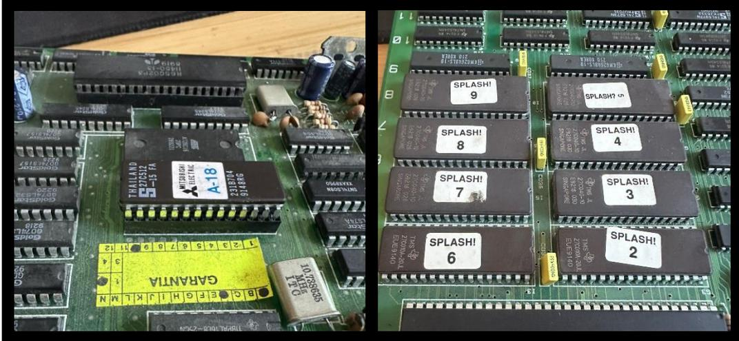
Imagen 23. De izquierda a derecha: Eprom insertada en zócalo perteneciente a PCB Bootleg con videojuego Tetris (Atari, 1989) y Eproms soldadas a la PCB pertenecientes a PCB con el videojuego Splash! (Gaelco, 1992). Imágenes propias.
