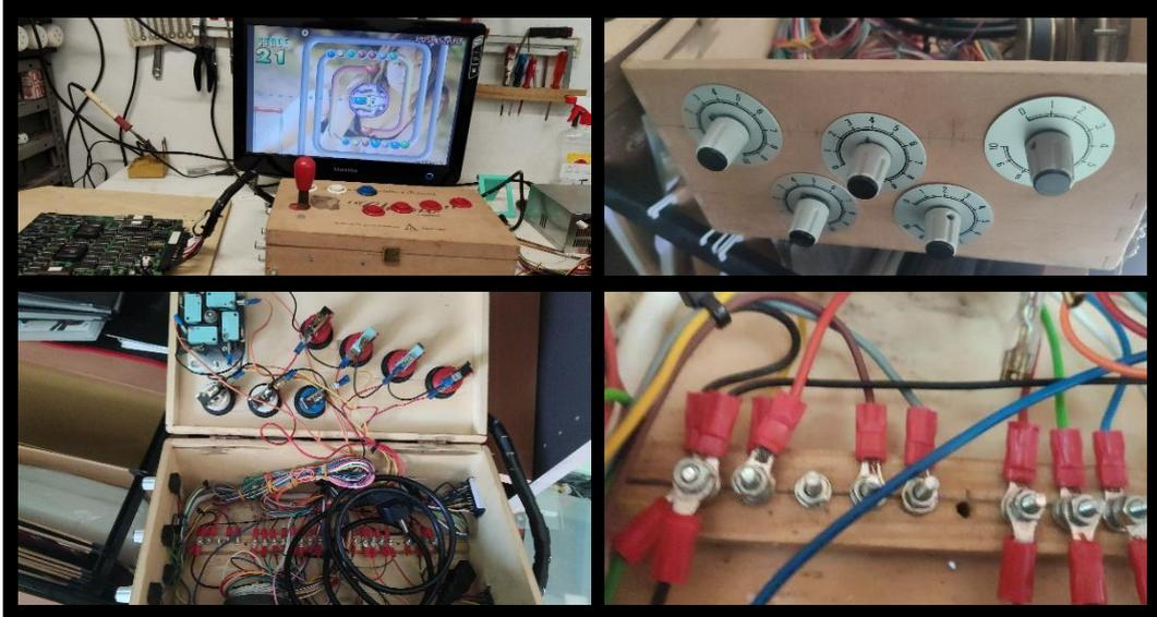
*Imagen 17. Segundo prototipo de Supergun realizado durante la investigación en el que se muestra reproduciendo el videojuego Lup Lup Puzzle (Omega System, 1999). Se muestran en detalle los controles de sincronismos (arriba derecha) y el sistema sin soldaduras realizado para probar conectores específicos diferentes al estándar de conexión Jamma (abajo derecha). Imágenes propias.*
