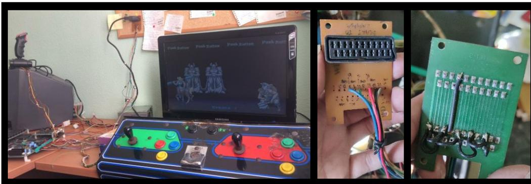
Imagen 15. Prototipo de primer Supergun realizado durante la investigación en el que se muestra reproduciendo el videojuego Golden Axe: The revenge of Death Adder (Sega, 1992). Se muestra en detalle la conexión del sistema Jamma a un conector SCART. Imágenes propias.
