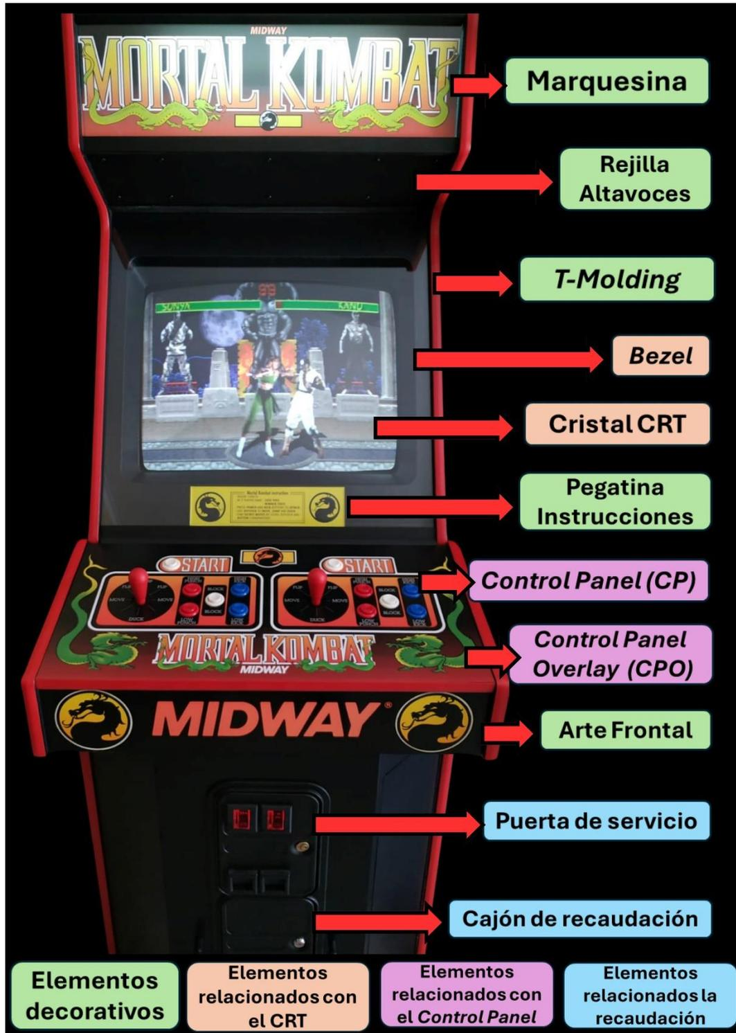
Imagen 20. Esquema de elementos exteriores de una máquina Arcade. Máquina restaurada modelo Mortal Kombat (Revsa, 1993). Imagen y esquema propios.
