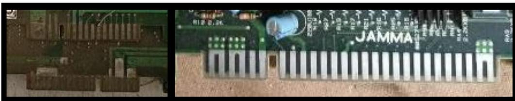
Imagen 6. De izquierda a derecha: Conectores específicos del PCB (Taito, 1980) del videojuego Astro Fighter (Data East, 1980) y conexión Jamma del PCB (Konami, 1990) del videojuego Parodius Da! (Konami, 1990). Imágenes propias.
