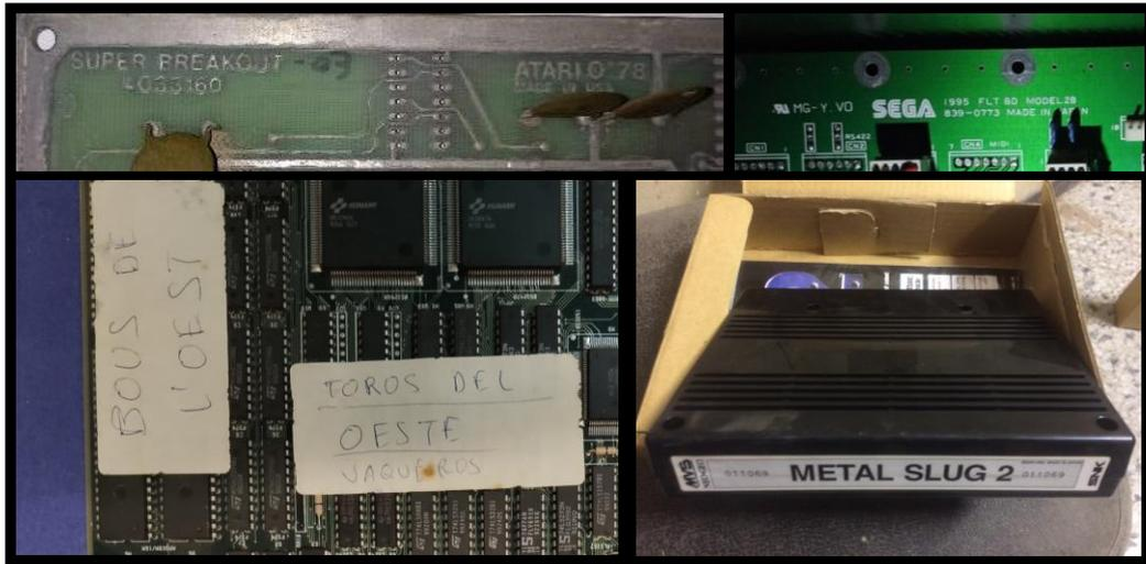
Imagen 13. Tipos de serigrafías. Arriba izquierda: serigrafía grabada en PCB modelo Super Breakout (Atari, 1978); arriba derecha: serigrafía grabada en PCB modelo Mode2B (Sega, 1995) para el videojuego Virtua Striker (Sega, 1995); abajo izquierda: anotación manuscrita por operador en la PCB para el videojuego Wild West C.O.W.-Boys of Moo Mesa (Konami, 1992); y pegatina indicadora del videojuego Metal Slug 2 (SNK, 1998) para el cartucho del sistema MVS. Imágenes propias.
