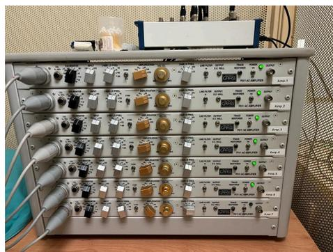
Figura 55. Amplificador de señal AC P511 de Grass Instruments. Fuente propia.
