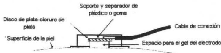
Figura 24. Diagrama de electrodo superficial del tipo flotante. Fuente: (UNAM)
