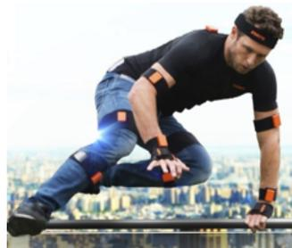
Figura 32. Traje de sistema inercial de captación de movimiento. Fuente: Xsens
