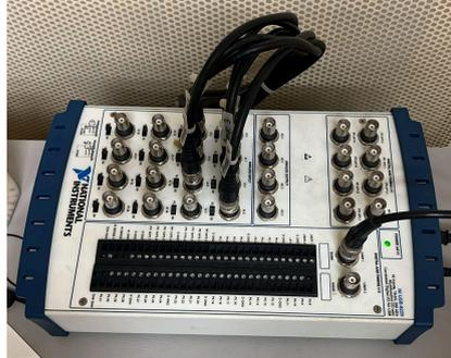
Figura 56. Tarjeta de adquisición de datos NI USB-6229. Fuente propia.
