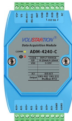
Figura 4.8: Ejemplo dispositivo ADM-4280-C empleado en la planta
