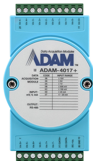
Figura 4.7: Ejemplo dispositivo ADAM 4017+ empleado en la planta
