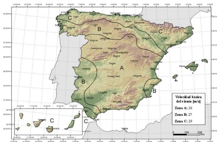
Figura 4. Valor básico de la velocidad del viento
