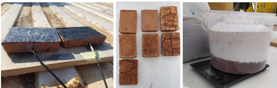
Ilustración 46: Medición de la temperatura interna de ambos sistemas (izq). Pruebas de ladrillos con diferentes – generación propia
