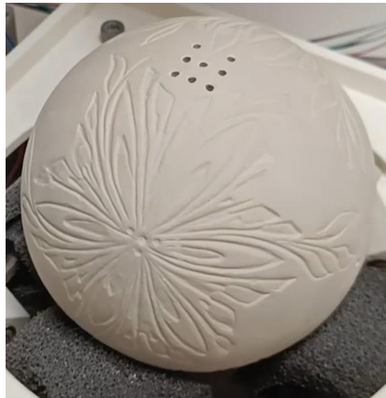
Ilustración 92. Buena calidad de perforaciones conseguidas a poca distancia.
