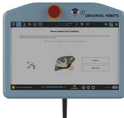
Ilustración 3. Imagen de un teach pendant perteneciente a un UR 5. Fuente: Automation Distribution.
