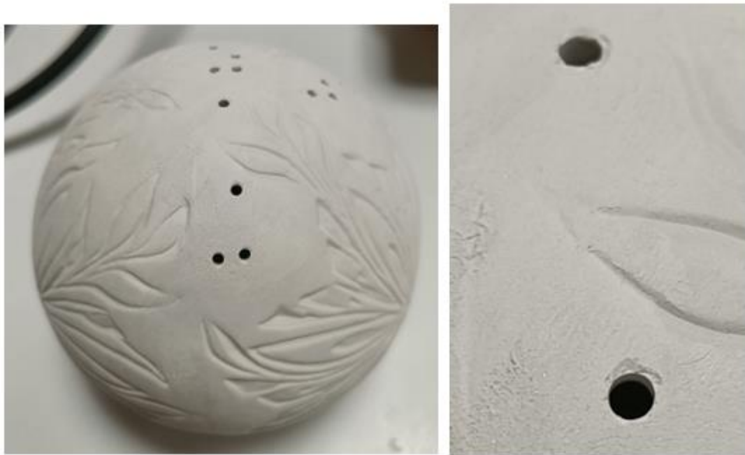
Ilustración 91. Cerámica con escamados cerca de la zona perforada
