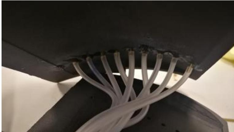
Figura 5.2.3. Conexión de los tubos de presión al extradós del perfil.
