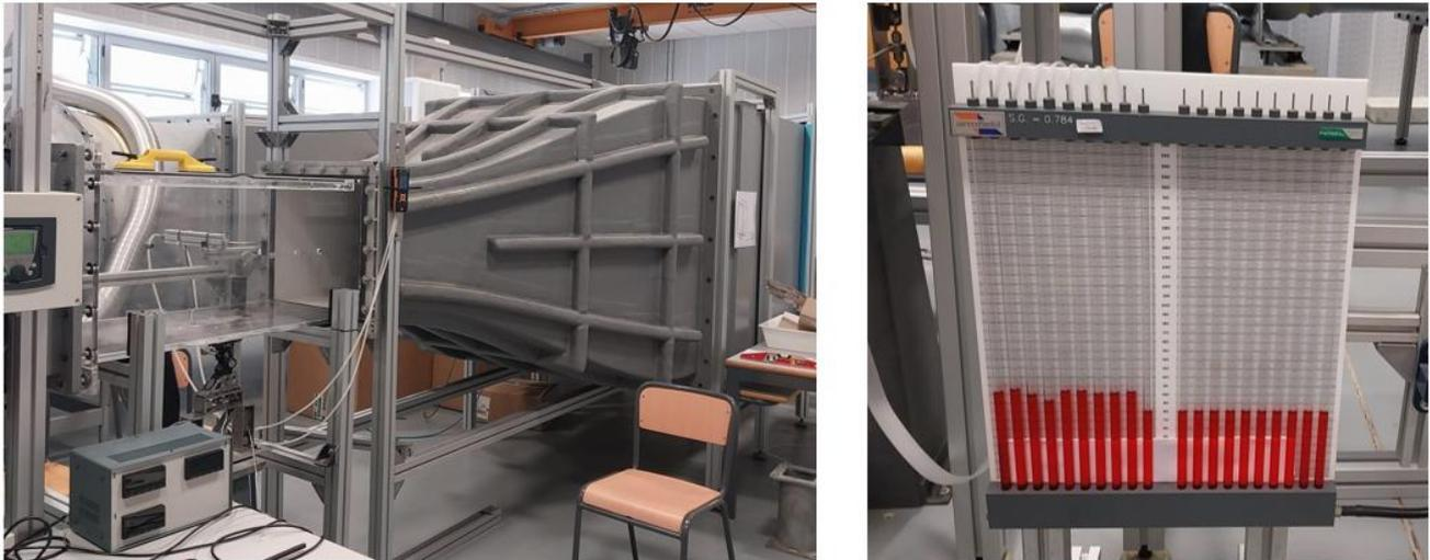
Figura 5.2.2. Túnel de viento (izquierda) y banco de presiones (derecha) utilizados para el estudio.
