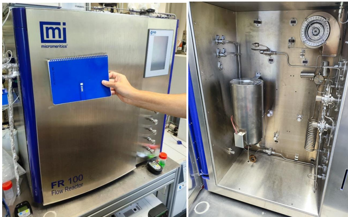
Ilustración 7: Fotos reactor PID FR 100 Flow Reactor
