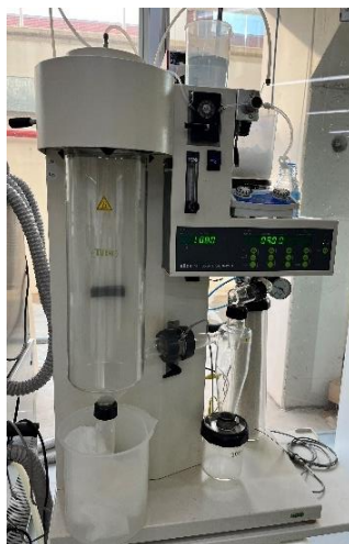
Figura 5. Equipo Buchi B-290 con una boquilla de tres fluidos.
