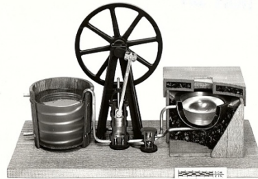
Ilustración 2-2 Máquina de refrigeración de Jacob Perkins. Fuente: americanhistory.si.edu
