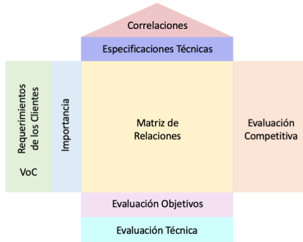
Ilustración 6. Diagrama Casa de la Calidad (QFD). Fuente: Elaboración propia. (Basado en Akao, 1997 y Mazur, 2014)
