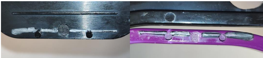
Ilustración 23. Fotos de detalle de la unión con adhesivos. Fuente: Elaboración propia.
