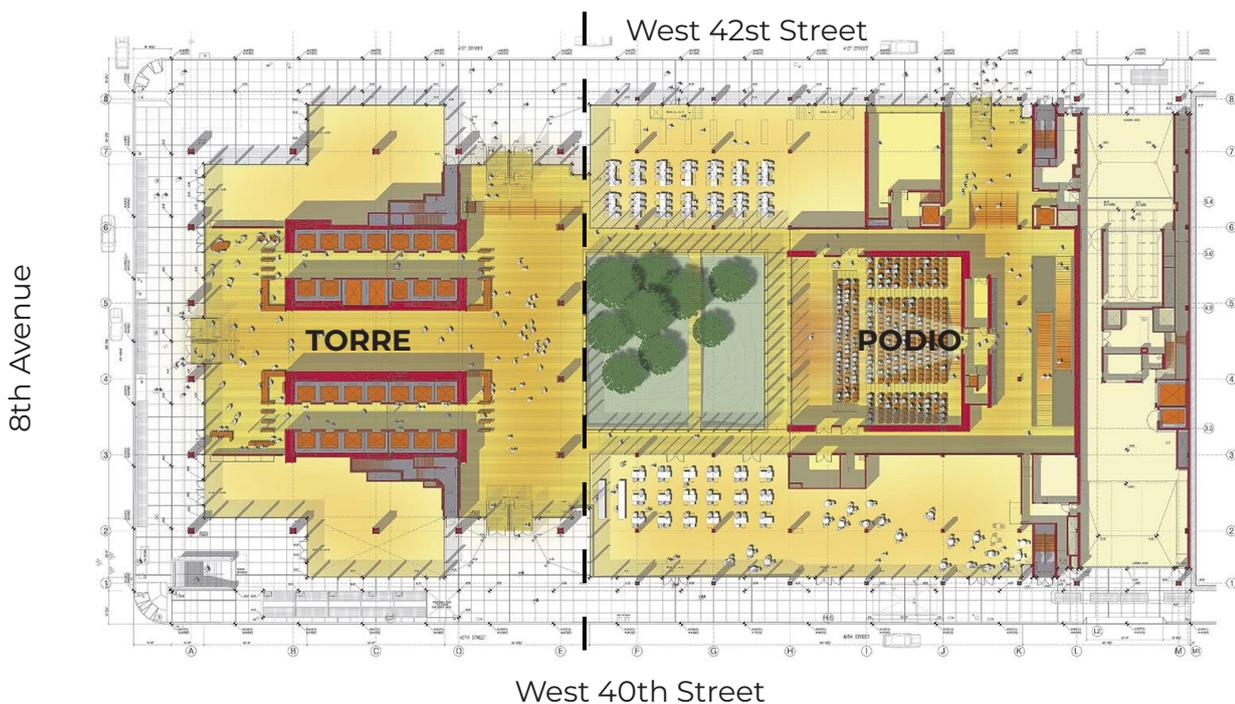
Fig.150. Planta baja edificio New York Times. Delimitación entre la torre y el podio.
