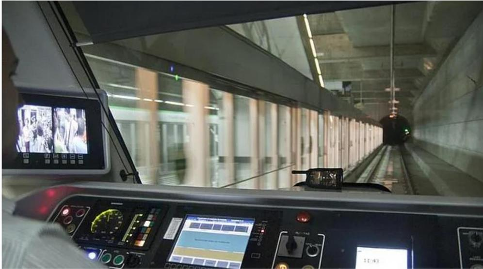
*Figura 13. Unidad del Metro de Sevilla equipado con el sistema ATO.*
