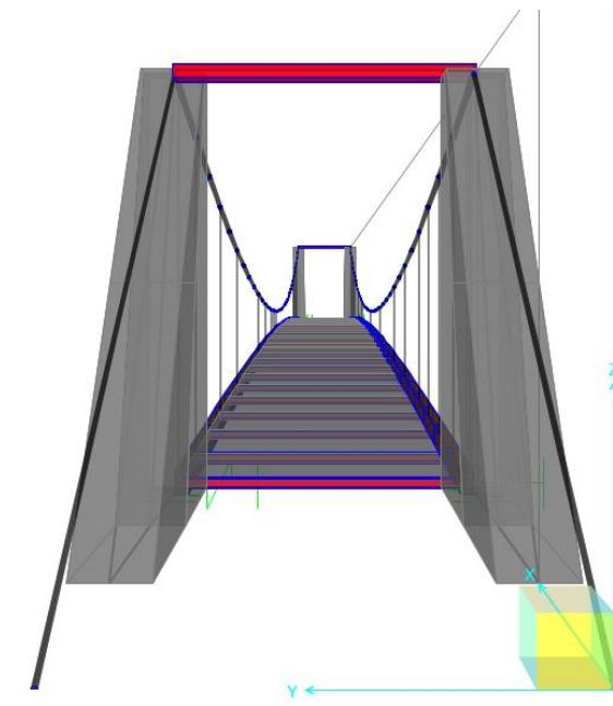
Figura 9: Definición geometría de pasarela 3D en el modelo SAP2000, vista en perfil
