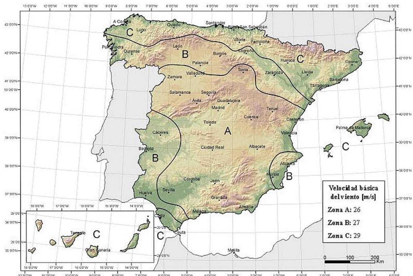
Figura 13: Mapa de zonas para la obtención de la velocidad básica fundamental del viento  $v_b$ .
