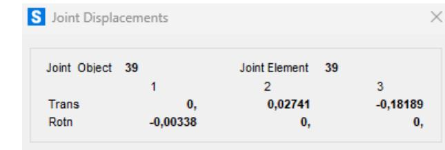
Figura 59: Asiento esperado proporcionado por modelo de cálculo
