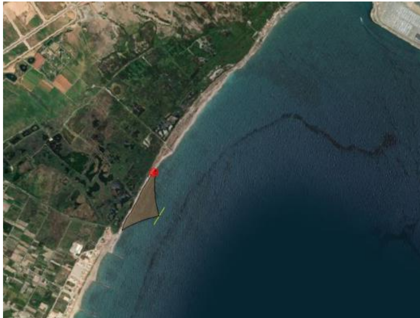
Figura 6 Representación estimada del tómbolo producido por el dique exento. Fuente: Elaboración propia.
