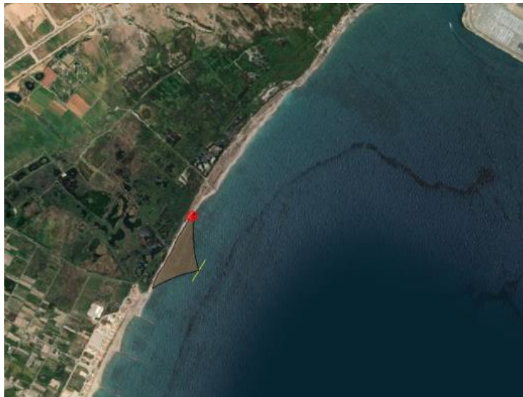
Figura 37 Representación estimada del tómbolo producido por el dique exento. Fuente: Elaboración propia.
