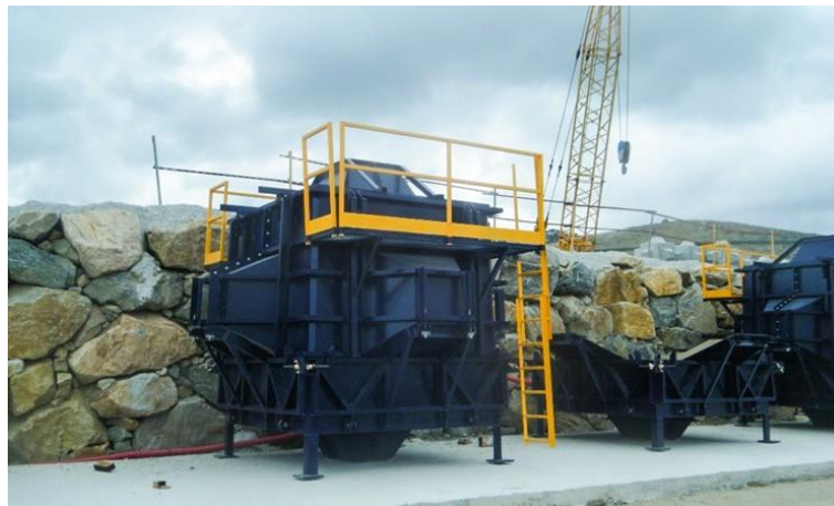
Figura 47 Cubípodo encofrado. Fuente: Web del Cubípod.
