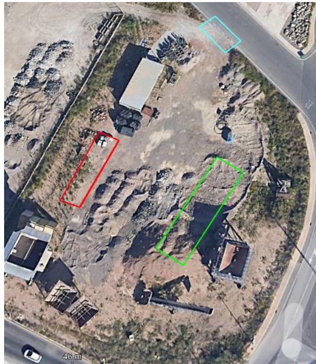
Figura 46 Propuesta de organización de las tareas de encofrado y acopio en planta. Fuente: Elaboración propia.
