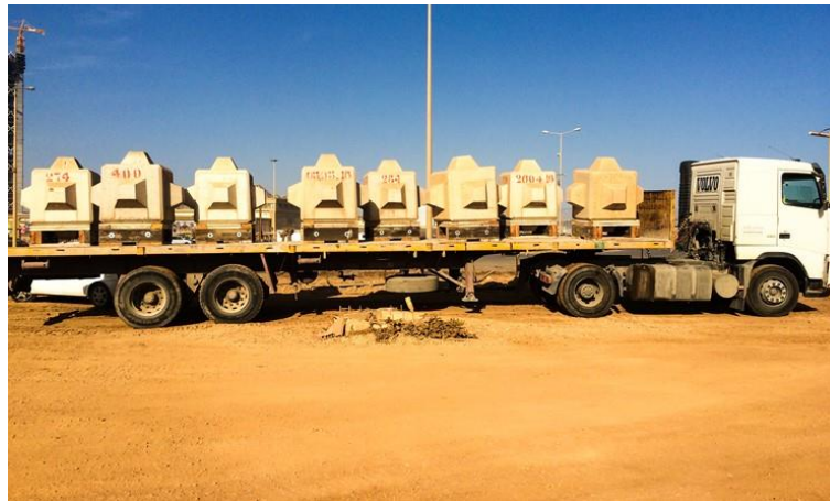
Figura 50 Transporte de Cubípodos. Fuente: Web del Cubípod.
