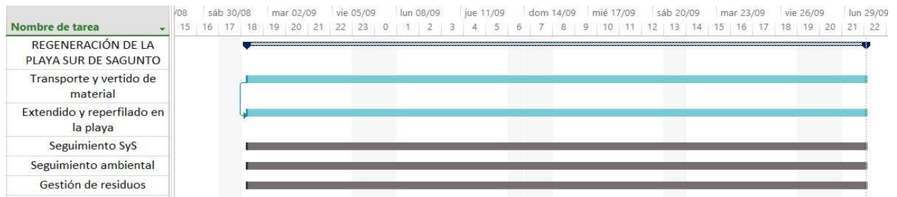
Figura 62 Propuesta de estimación del plan de obra de la regeneración con árido de cantera. Fuente: Elaboración propia.
