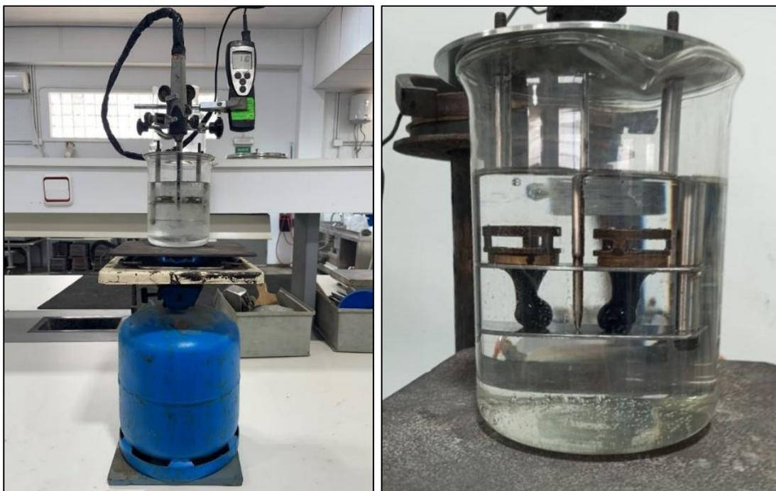
FIGURA 22. ENSAYO ANILLO Y BOLA. FUENTE. ELABORACIÓN PROPIA.
