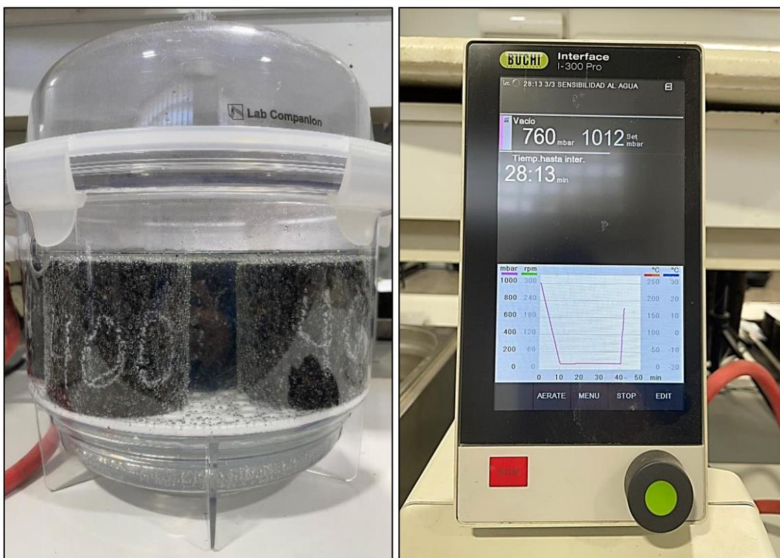
FIGURA 39. EJEMPLO DEL PROCESO DE VACÍO EN EL ACONDICIONAMIENTO DE PROBETAS HÚMEDAS. FUENTE: ELABORACIÓN PROPIA.
