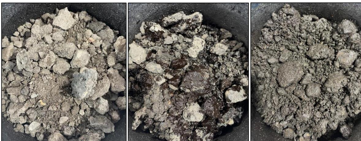
FIGURA 36. EVOLUCIÓN DE LAS DISTINTAS FASES DE MEZCLADO. FUENTE: ELABORACIÓN PROPIA.
