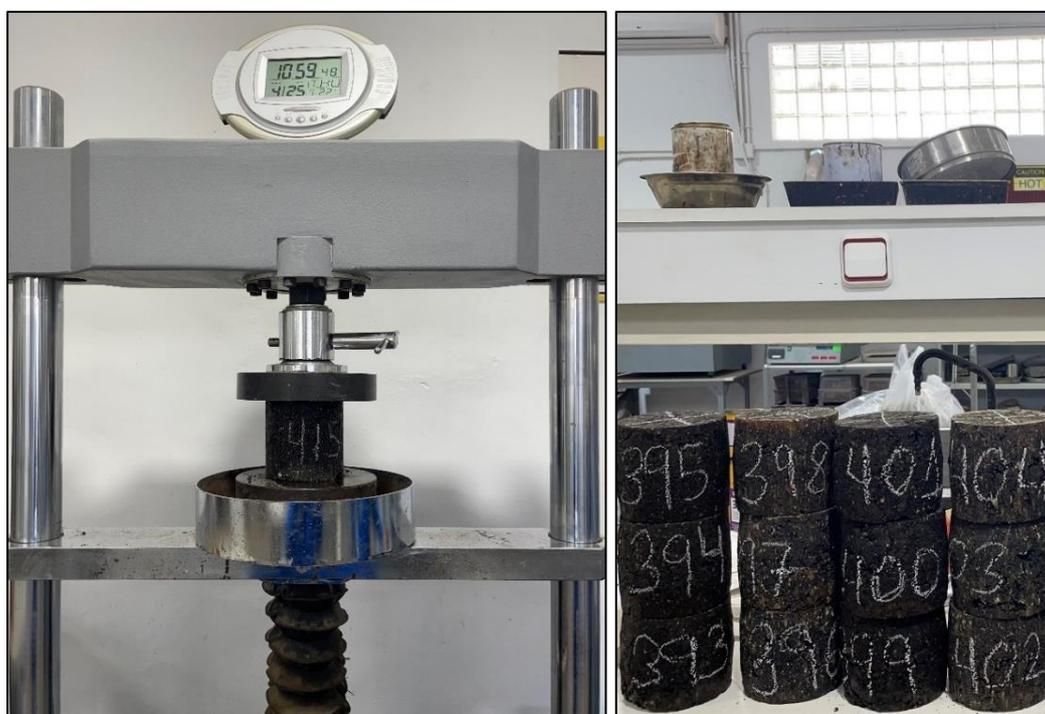
FIGURA 37. PRENSA HIDRÁULICA DEL LABORATORIO UTILIZADA. FUENTE: ELABORACIÓN PROPIA.
