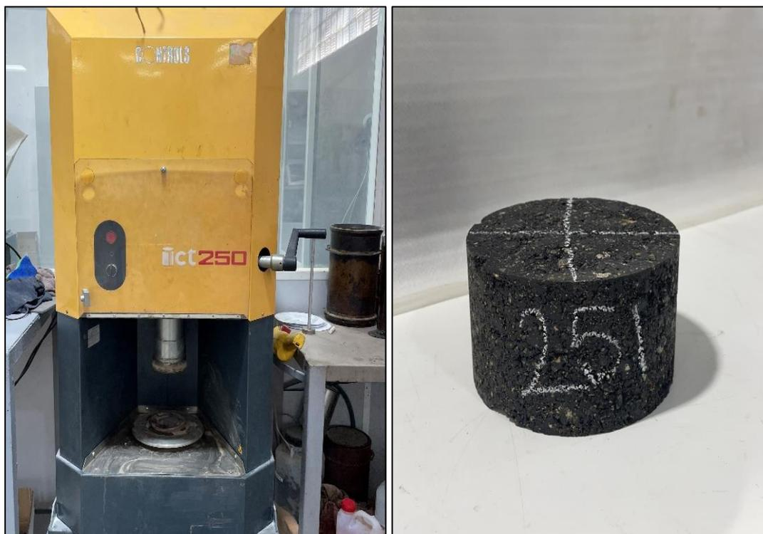
FIGURA 38. MÁQUINA COMPACTADORA GIRATORIA Y PROBETA REALIZADA CON ESTE MÉTODO. FUENTE: ELABORACIÓN PROPIA.
