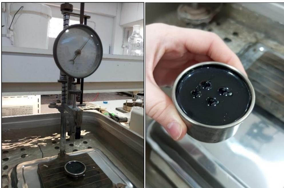
FIGURA 21. ENSAYO PENETRACIÓN. FUENTE: ELABORACIÓN PROPIA.
