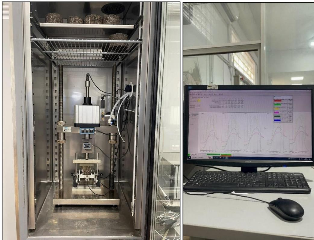
FIGURA 40. ENSAYO MÓDULO RESILIENTE SEGÚN NORMA UNE-EN 12697-26. FUENTE: ELABORACIÓN PROPIA.
