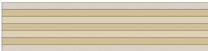
Figure 40 : Panneau CLT 240 L7s. Figure tirée du logiciel CLT Designer.
