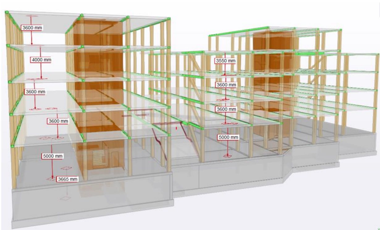
Figure 35 : Extrait du modèle BIM du bâtiment Saggården. Ossature bois et noyaux en CLT.
