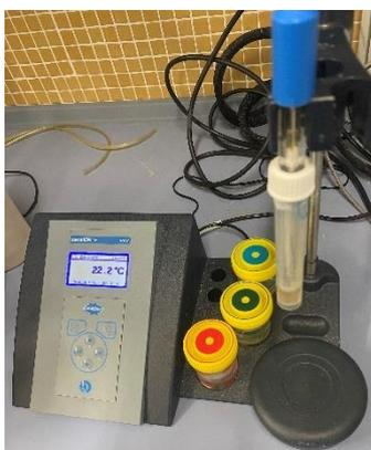
Figura 14 Medidor de pH HACH Sension+
