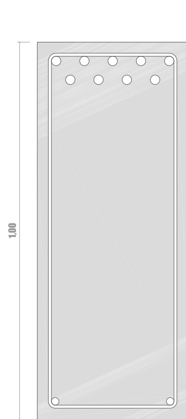
Biga llum 14 m Secció sobre pilars
