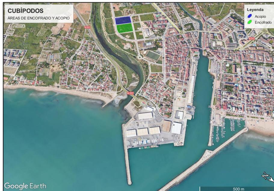
*Imagen 4. Ubicación de la zona de acopio y encofrado de cubípodos (Fuente: Google earth)*
