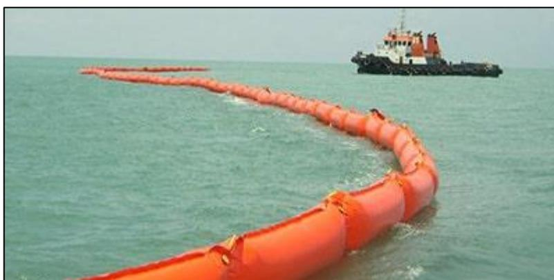
Imagen 6. Barrera de contención (Fuente: elastec.com)
