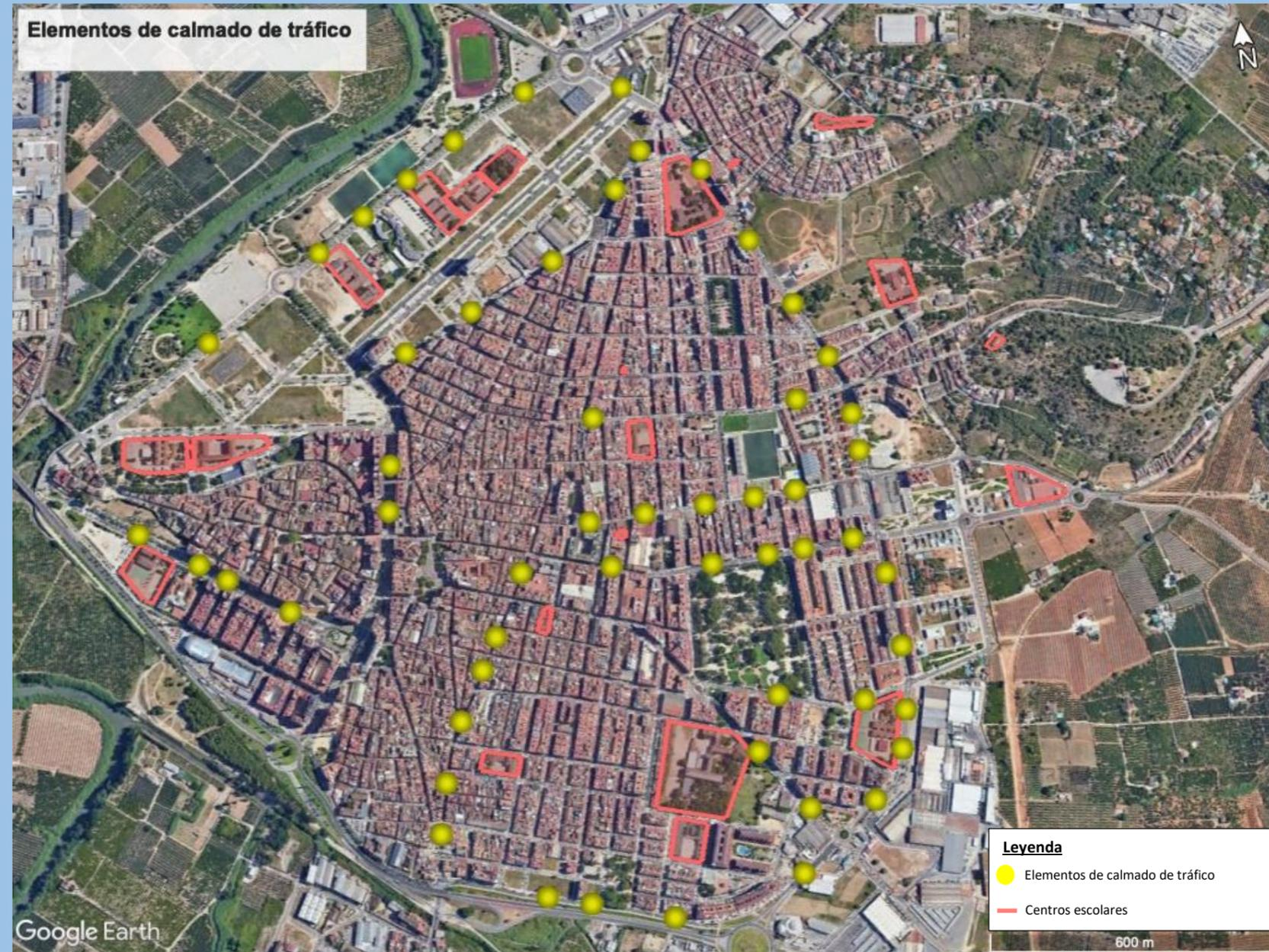
Figura 55. Ubicación de los elementos de calmado de tráfico propuestos. Fuente: Elaboración propia mediante Google Earth
