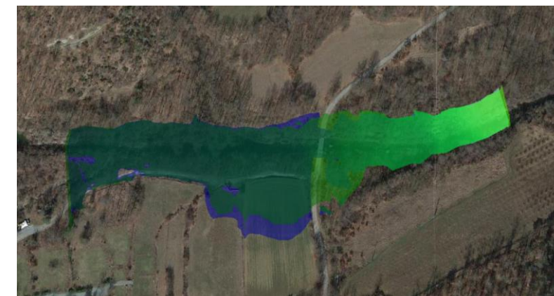
Figura 18. Comparación de inundación con T=100 y T=500. Elaboración propia con HEC RAS.
