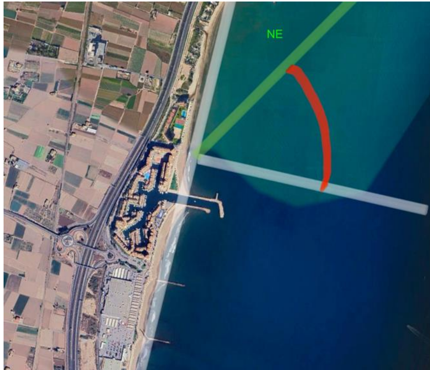
Figura 70, procedimiento de cálculo del ángulo que forma el oleaje respecto a la perpendicular a la costa (fuente: elaboración propia).
