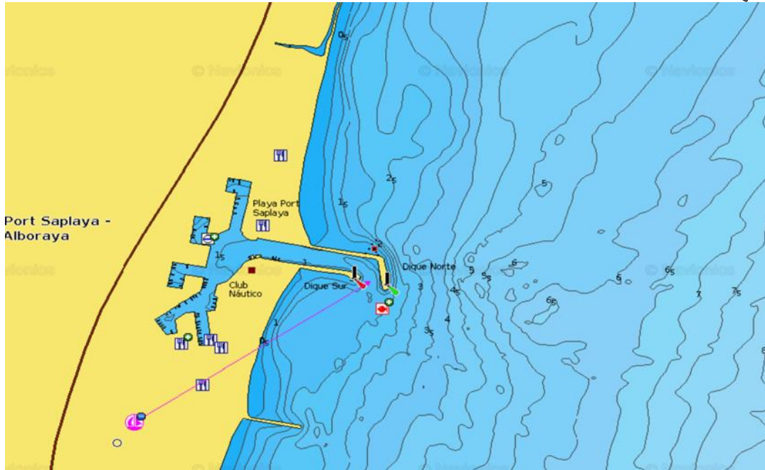
Figura 13. Batimetría a pie de dique (fuente: Navionics).
