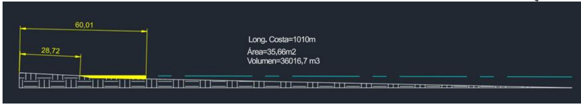
Figura 30, perfil de playa definitivo para la obtención del volumen de aportación (fuente: elaboración propia).
