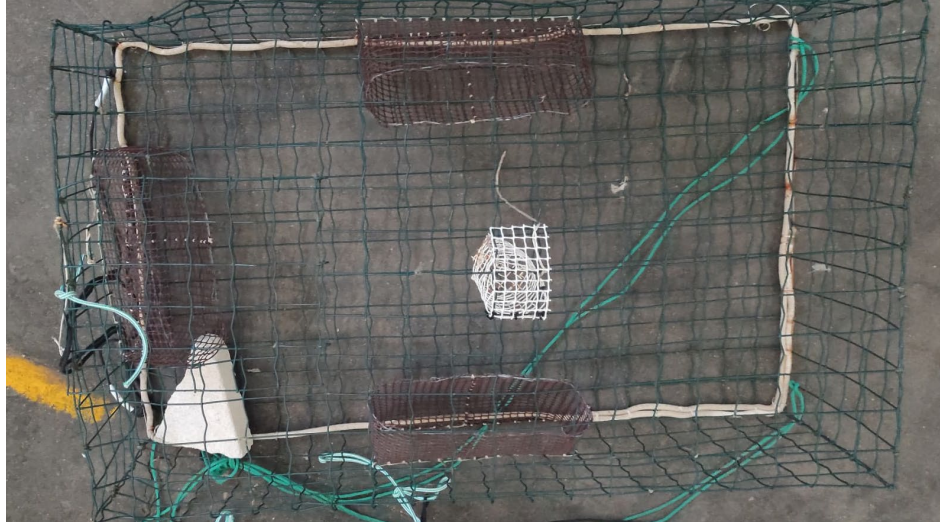
Figura 3.9. Trampa rectangular con medidas: Altura: 29,7 cm; largo: 101,6; ancho: 61 cm; diámetro de la entrada de los cangrejos: 30,1x 8,7 cm; profundidad de la entrada: 19,4 cm; malla 4,8x 4,8 cm. Presenta 3 entradas laterales. Y tiene un compartimiento en forma de tubo para depositar el cebo.
