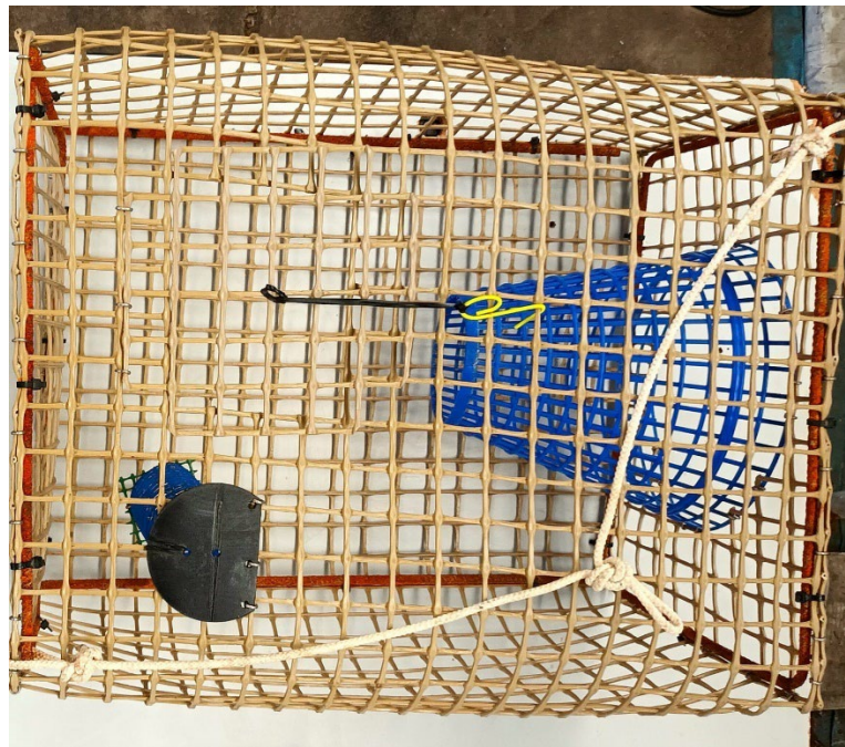
Figura 3.8. Trampa ECESIS con medidas: Altura: 36 cm; largo: 64,6; ancho: 49,4 cm; diámetro exterior de la abertura de la trampa: 26.8 cm; diámetro interior de la abertura de la trampa: 11 cm; malla 3,1x 3,1 cm. Presenta una sola entrada lateral con forma cilíndrica con diferentes diámetros de apertura ambos extremos. Y tiene un compartimiento en forma de tubo para depositar el cebo.
