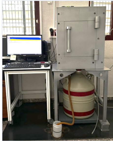
Figura 18. Ejemplo detector de germanio ultrapuro del Laboratorio de Radiactividad Ambiental de la UPV. Fuente: Elaboración propia.
