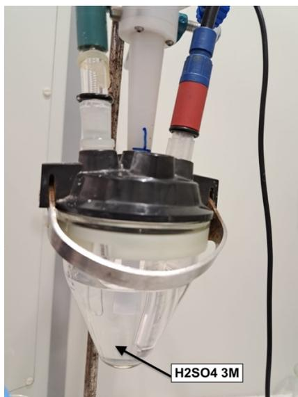
**Figura 17.** Montaje para el pretratamiento de los electrodos con  $\text{H}_2\text{SO}_4$  3 M.
