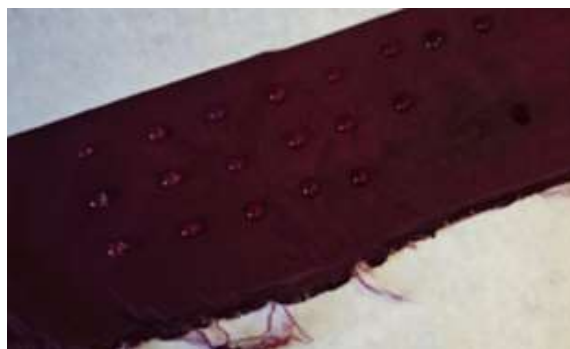
Fig. 85: Assaig del tractament oleòfug.
