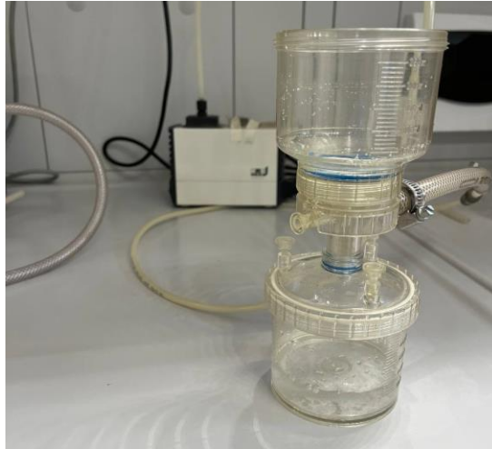
Ilustración 1. Filtro a vacío utilizado (imagen propia).
