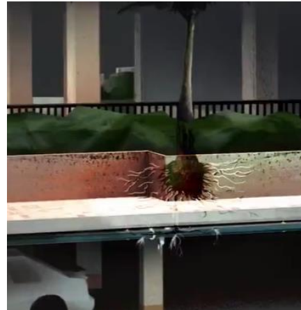
Figura 26. Intrusión de las raíces sobre la losa y las tuberías [18]
