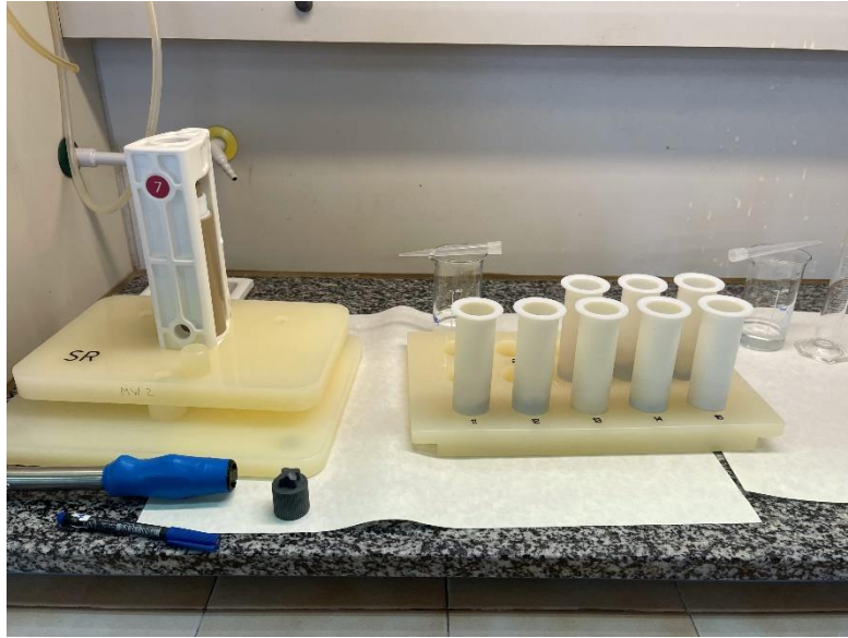
Figura 39. Preparación de las muestras para el microondas.
