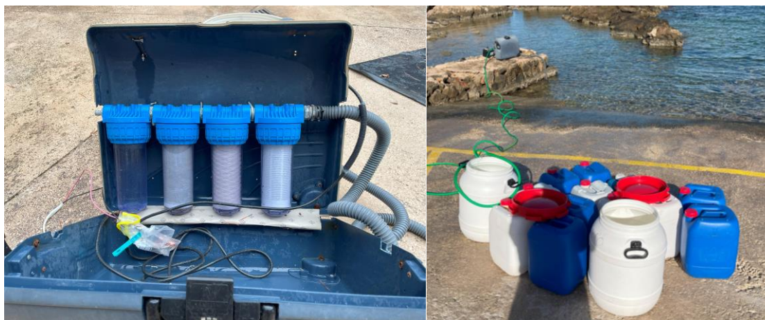
Figura 5. Sistema de captación y filtración del agua.
