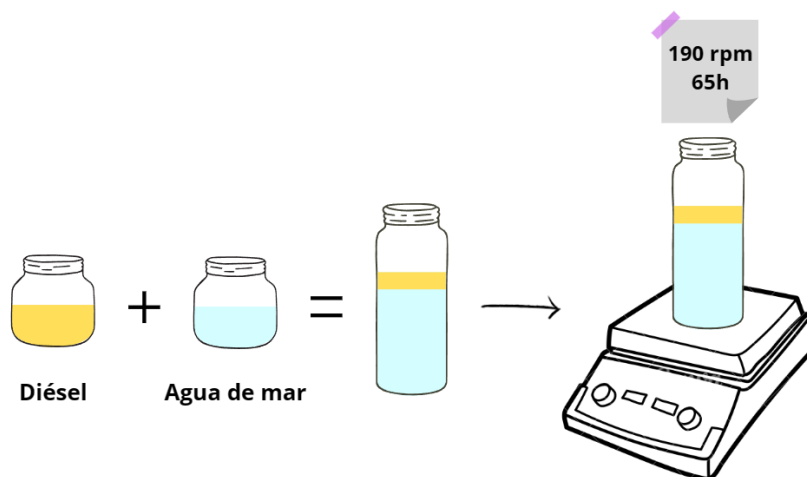
Figura 6. Esquema de la preparación de la mezcla diésel + agua de mar (ratio 1:1000).
