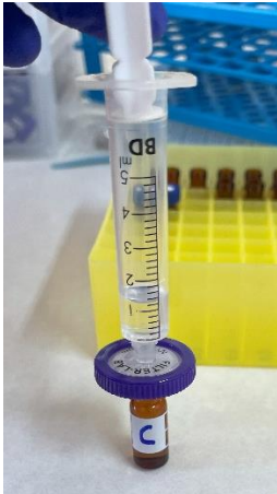
Figura 44. Filtración de las muestras para el cromatógrafo.
